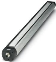
LED-Maschinenleuchte, 24 V DC, Abstrahlwinkel (vertikal/horizontal): 75 °/95 °, Länge: 790 mm, Durchmesser: 70 mm, Schutzart: IP67, schwenkbar, resistent gegen Kühl- und Schmiermittel
