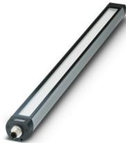
LED-Maschinenleuchte, 24 V DC, Abstrahlwinkel (vertikal/horizontal): 85 °/95 °, Länge: 540 mm, Durchmesser: 40 mm, Schutzart: IP67, schwenkbar, resistent gegen Kühl- und Schmiermittel
