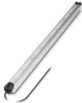
LED-Maschinenleuchte, 24 V DC, Abstrahlwinkel (vertikal/horizontal): 95 °/105 °, Länge: 616 mm, Schutzart: IP67, schwenkbar, inklusive Montagezubehör
