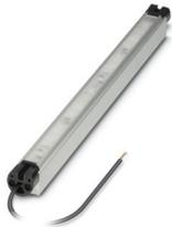
LED-Maschinenleuchte, 24 V DC, Abstrahlwinkel (vertikal/horizontal): 95 °/105 °, Länge: 336 mm, Schutzart: IP67, schwenkbar, inklusive Montagezubehör
