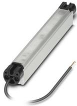
LED-Maschinenleuchte, 24 V DC, Abstrahlwinkel (vertikal/horizontal): 95 °/105 °, Länge: 196 mm, Schutzart: IP67, schwenkbar, inklusive Montagezubehör
