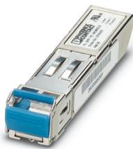
FastEthernet SFP-WDM-Modul für Übertragung bis maximal 20 km auf einer Faser mit einer Wellenlänge von 1310/1550 nm.
