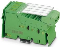
Inline, Dehnungsmessstreifen-Erfassungsklemme, Übertragungsgeschwindigkeit im Lokalbus: 500 kBit/s, 2 präzise und schnelle Eingänge, 4-, 6-Leiter-Anschlusstechnik, Schutzart: IP20, inklusive Inline-Steckern und Beschriftungsfeldern
