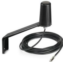
Multiband-Rundstrahlantenne für Wand- oder Mastmontage, 0,6 GHz ... 6 GHz, Gewinn: 3 dBi ... 7 dBi, Schutzart: IP66, Anschluss: SMA (male), inkl. 5-m-Anschlusskabel, Montagewinkel und Mastschellen
