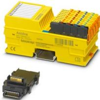
Axioline F, Digitaleingabemodul, Funktionale Sicherheit, SafetyBridge Technology, Digitale Eingänge: 4 (bei 2-kanaliger Belegung), 8 (bei 1-kanaliger Belegung), 24 V DC, Anschlusstechnik: 2-, 3-, 4-Leiter, Schutzart: IP20
