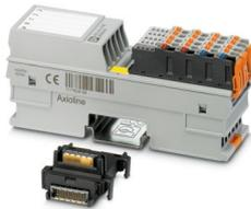
Axioline F, Analogausgabemodul, Analoge Ausgänge: 4, 0 V ... 5 V, -5 V ... 5 V, 0 V ... 10 V, -10 V ... 10 V, 0 mA ... 20 mA, 4 mA ... 20 mA, Anschlusstechnik: 2-Leiter, Übertragungsgeschwindigkeit im Lokalbus: 100 MBit/s, Extreme Conditions-Variante, Schutzart: IP20, inklusive Bussockelmodul und Axioline F-Steckern
