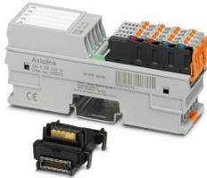
Axioline F, Analogein-/ausgabemodul, Analoge Eingänge: 2, 0 V ... 5 V, -5 V ... 5 V, 0 V ... 10 V, -10 V ... 10 V, 0 mA ... 20 mA, 4 mA ... 20 mA, -20 mA ... 20 mA, Anschlusstechnik: 2-Leiter, Analoge Ausgänge: 2, 0 V ... 5 V, -5 V ... 5 V, 0 V ... 10 V, -10 V ... 10 V, 0 mA ... 20 mA, 4 mA ... 20 mA, -20 mA ... 20 mA, Anschlusstechnik: 2-Leiter, Übertragungsgeschwindigkeit im Lokalbus: 100 MBit/s, Schutzart: IP20, inklusive Bussockelmodul und Axioline F-Steckern
