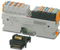
Axioline F, Digitalein-/ausgabemodul, Digitale Eingänge: 8, 24 V DC, Anschlusstechnik: 3-Leiter, Digitale Ausgänge: 8, 24 V DC, 500 mA, Anschlusstechnik: 3-Leiter, Übertragungsgeschwindigkeit im Lokalbus: 100 MBit/s, Schutzart: IP20, inklusive Bussockelmodul und Axioline F-Steckern
