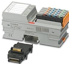
Axioline F, Digitalausgabemodul, Digitale Ausgänge: 4 (Triac-Ausgänge mit Nullspannungsschalter), 230 V AC, 2 A, Anschlusstechnik: 3-Leiter, Übertragungsgeschwindigkeit im Lokalbus: 100 MBit/s, Schutzart: IP20, inklusive Bussockelmodul und Axioline F-Steckern
