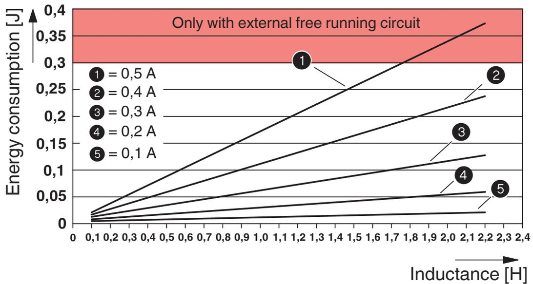
Maximale Energieaufnahme der Ausgänge beim Abschalten induktiver Lasten
