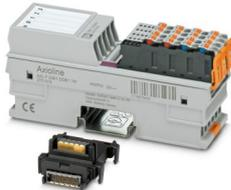
Axioline F, Digitalein-/ausgabemodul, Digitale Eingänge: 8, 24 V DC, Anschlusstechnik: 1-Leiter, Digitale Ausgänge: 8, 24 V DC, 500 mA, Anschlusstechnik: 1-Leiter, Extreme Conditions-Variante, Übertragungsgeschwindigkeit im Lokalbus: 100 MBit/s, Schutzart: IP20, inklusive Bussockelmodul und Axioline F-Steckern
