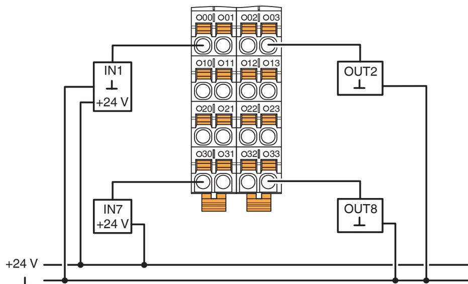
Beispielhafter Anschluss von Sensoren und Aktoren beim Einsatz von externen Potenzialschienen
