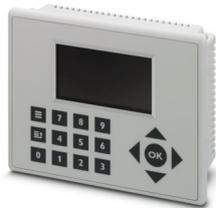
Fernbedienoberfläche für Nanoline- und ILC 1...-Steuerungen. RS-232-Schnittstelle ermöglicht Montage in bis zu 15 m Entfernung.
