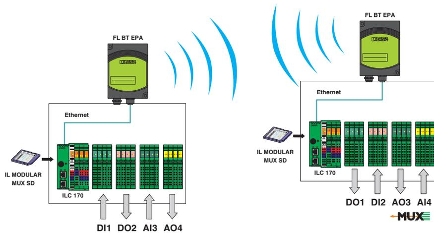
Die Software auf der CompactFlash®-Karte SD FLASH 512MB MODULAR MUX macht aus dem ILC 131 ETH und den individuell benötigten Ein- und Ausgabeklemmen einen flexiblen Feldmultiplexer. Als Wireless oder in einem Ethernet-Netzwerk als Punkt-zu-Punkt-Verbindung.
