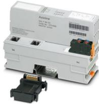
Axioline F, Buskoppler, Sercos, RJ45-Buchse, Übertragungsgeschwindigkeit im Lokalbus: 100 MBit/s, Schutzart: IP20, inklusive Bussockelmodul und Axioline F-Stecker
