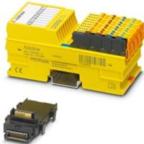
Axioline F, Digitaleingabemodul, Funktionale Sicherheit, PROFIsafe, ausschließlich zum Anschluss an Phoenix Contact- oder Siemens-Steuerung, Digitale Eingänge: 4 (bei 2-kanaliger Belegung), 8 (bei 1-kanaliger Belegung), 24 V DC, Anschlusstechnik: 2-, 3-, 4-Leiter, Schutzart: IP20
