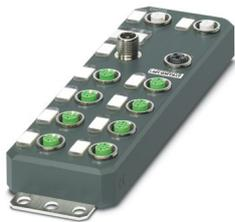
Axioline E, Digitalein-/ausgabegerät, EtherCAT®, M12-Steckverbinder, Digitale Eingänge: 16, 24 V DC, Anschlusstechnik: 4-Leiter, Digitale Ausgänge: 16, 24 V DC, Anschlusstechnik: 3-Leiter, Kunststoffgehäuse, Schutzart: IP65/IP67
