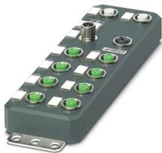
Axioline E, Digitaleingabegerät, PROFINET, M12-Steckverbinder, Digitale Eingänge: 16, 24 V DC, Anschlussstechnik: 4-Leiter, Kunststoffgehäuse, Schutzart: IP65/IP67
