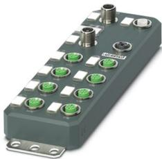
Axioline E, PROFIBUS DP, M12-Steckverbinder, IO-Link-Ports Class A: 4, Anschlussart: M12-Steckverbinder, Anschlusstechnik: 3-Leiter, IO-Link-Ports Class B: 4, Anschlussart: M12-Steckverbinder, Anschlusstechnik: 3-Leiter, Digitale Eingänge an Pin 2 bei Class-A-Ports: 4, 24 V DC, Anschlusstechnik: 3-Leiter, Kunststoffgehäuse, Schutzart: IP65/IP67
