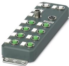
Axioline E, EtherNet/IP™, M12-Steckverbinder, IO-Link-Ports Class A: 4, Anschlussart: M12-Steckverbinder, Anschlusstechnik: 3-Leiter, IO-Link-Ports Class B: 4, Anschlussart: M12-Steckverbinder, Anschlusstechnik: 3-Leiter, Digitale Eingänge an Pin 2 bei Class-A-Ports: 4, 24 V DC, Anschlusstechnik: 3-Leiter, Kunststoffgehäuse, Schutzart: IP65/IP67
