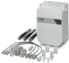
Schaltkasten-Set zum Aufbau von Funksystemen für Industrieanwendungen, inkl. drei direkt aufschraubbaren Rundstrahlantennen 2,4 / 5 GHz, IP66, mit Tragschiene, Stopfen und Verschraubungen, mit Netzteil 100 V ... 240 V, ohne Geräte
