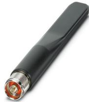
Rundstrahlantenne für Schaltschrankmontage, Frequenzband: 2,4 GHz / 5 GHz, Gewinn: 2,5 dBi / 5 dBi, Schutzart: IP68, Anschluss: N (male)
