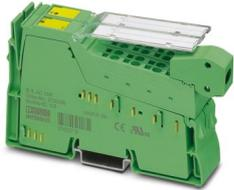
Inline, Analogausgabeklemme, Analoger Ausgang: 1, 0 V ... 10 V, 0 mA ... 20 mA, 4 mA ... 20 mA, Anschlusstechnik: 2-Leiter, Übertragungsgeschwindigkeit im Lokalbus: 500 kBit/s, Extreme Conditions-Variante, Schutzart: IP20, inklusive Inline-Steckern und Beschriftungsfeldern
