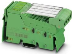
Inline, Analogeingabeklemme, Analoge Eingänge: 4, 0 V ... 5 V, -5 V ... 5 V, 0 V ... 10 V, -10 V ... 10 V, 0 mA ... 20 mA, 4 mA ... 20 mA, -20 mA ... 20 mA, Anschlusstechnik: 2-, 3-, 4-Leiter, Übertragungsgeschwindigkeit im Lokalbus: 500 kBit/s, Extreme Conditions-Variante, Schutzart: IP20, inklusive Inline-Steckern und Beschriftungsfeldern
