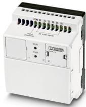
24 V DC Nanoline-Basiseinheit. Ausgestattet mit 6 digitalen Eingangs- und 4 digitalen PNP-Ausgangskanälen. I/O-Kanäle können hinzugefügt und maximal 3 I/O-Erweiterungsmodule verwendet werden. Optionale Kommunikationsmodule ermöglichen Netzwerk- oder serielle Connectivity. Optionales Bediengerät mit Benutzeroberfläche. Programmierung mittels Nano-Navigator.
