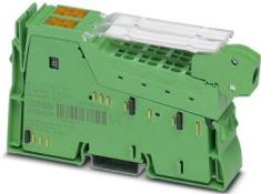
Inline, Kommunikationsklemme, Schnittstelle RS-232, RS-485, RS-422: 1 (alternativ betreibbar), Übertragungsgeschwindigkeit im Lokalbus: 500 kBit/s, Schutzart: IP20, inklusive Inline-Steckern und Beschriftungsfeldern
