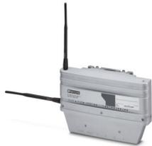
WLAN Access Point für USA und Kanada, 24 V DC, PoE, IEEE 802.11 a/b/g, 2,4 GHz, 5 GHz, Client-Adapter, Antenna Diversity, Web-based Management, 802.11i, WPA2, WPA-PSK, RADIUS, WEP, TKIP, AES
