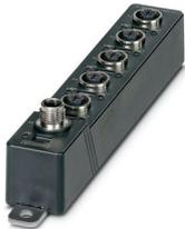
Unmanaged Switch 1600 Serie, 5 M12-Ports 10/100 MBit/s, Schutzart: IP65/IP66/IP67, Umgebungstemperatur (Betrieb): -40 °C ... 70 °C, Versorgungsspannungsbereich: 9 V DC ... 32 V DC, PROFINET Conformance-Class A
