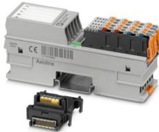
Axioline F, Temperaturerfassungsmodul, Analoge Eingänge: 4 (4 Eingänge für Thermoelemente oder lineare Spannung, zusätzlich 1 Eingang -5 V bis +5 V), Anschlusstechnik: 2-Leiter (geschirmt, paarig verdreht), Übertragungsgeschwindigkeit im Lokalbus: 100 MBit/s, Schutzart: IP20, inklusive Bussockelmodul und Axioline F-Steckern
