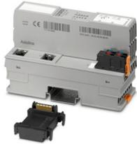
Axioline F, Buskoppler, EtherNet/IP™, RJ45-Buchse, Übertragungsgeschwindigkeit im Lokalbus: 100 MBit/s, Schutzart: IP20, inklusive Bussockelmodul und Axioline F-Stecker
