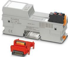
Axioline F, Nachspeisemodul für die Logikversorgung  $U_{\text{Bus}}$ , max. 4 A, Übertragungsgeschwindigkeit im Lokalbus: 100 MBit/s, Schutzart: IP20, inklusive Bussockelmodul und Axioline F-Stecker
