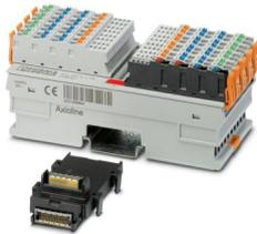
Axioline F, Digitalausgabemodul, Digitale Ausgänge: 16, 24 V DC, 500 mA, Anschlusstechnik: 3-Leiter, Übertragungsgeschwindigkeit im Lokalbus: 100 MBit/s, Schutzart: IP20, inklusive Bussockelmodul und Axioline F-Steckern
