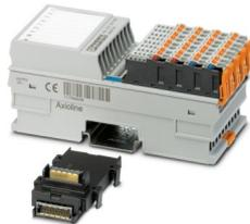
Axioline F, Digitaleingabemodul, Digitale Eingänge: 32, 24 V DC, Anschlusstechnik: 1-Leiter, Übertragungsgeschwindigkeit im Lokalbus: 100 MBit/s, Schutzart: IP20, inklusive Bussockelmodul und Axioline F-Steckern
