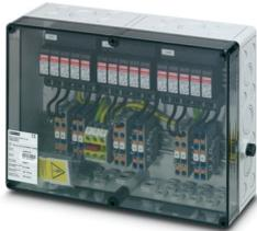
Generatoranschlusskasten für Photovoltaikanlagen bis 1000 V DC zum Anschluss von 6x 1 String. Mit Überspannungsschutz (Typ 1/2) und Kabelverschraubungen für die Eingangs- und Ausgangsseite.
