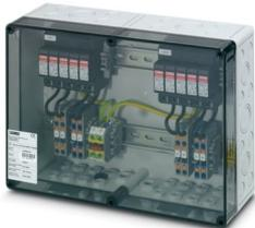
Generatoranschlusskasten für Photovoltaikanlagen bis 1000 V DC zum Anschluss von 4x 1 String. Mit Überspannungsschutz (Typ 1/2) und Kabelverschraubungen für die Eingangs- und Ausgangsseite.
