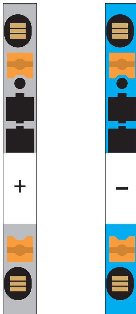
Anschluss der PV-Strings, sowie Anschluss zum Wechselrichter
