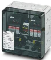
Generatoranschlusskasten für Photovoltaikanlagen bis 1000 V DC zum Anschluss von 2x 1 String. Mit Überspannungsschutz (Typ 2) und SUNCLIX-DC-Steckverbindern für die Eingangs- und Ausgangsseite (SUNCLIX-Gegenstecker im Lieferumfang).
