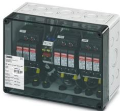
Generatoranschlusskasten für Photovoltaikanlagen bis 1000 V DC zum Anschluss von 3x 1 String. Mit Überspannungsschutz (Typ 2) und SUNCLIX-DC-Steckverbindern für die Eingangs- und Ausgangsseite (SUNCLIX-Gegenstecker im Lieferumfang).
