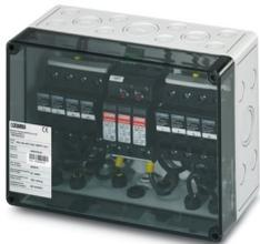
Generatoranschlusskasten für Photovoltaikanlagen bis 1000 V DC zum Anschluss von 1x 4 Strings. Mit Überspannungsschutz (Typ 1/2), Sicherungshaltern und SUNCLIX-DC-Steckverbindern für die Eingangs- und Ausgangsseite (SUNCLIX-Gegenstecker im Lieferumfang).
