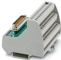
VARIOFACE-Modul, mit Schraubanschluss und High-Density-D-SUB-Miniatur-Stiftleiste, zur Montage auf NS 35-Tragschienen, Polzahl: 44, Breite: 135 mm
