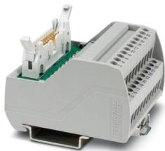
VARIOFACE-Modul, mit Schraubanschluss und Flachbandkabel-Steckverbinder, zur Montage auf NS 35-Tragschienen, mit Stiftleiste sowie kurzen und langen Verriegelungsbügeln für Buchsenleisten, Polzahl: 20, mit LED
