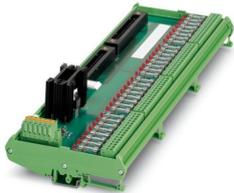
Übergabemodul für Yokogawa I/O-Baugruppen ADV 151, ADV 161, ADV 551 und ADV 561 mit einer Sicherung zum Leitungsschutz (5 x 20) und Sicherungsausfallanzeige (LED) pro Kanal. Redundanter Systemanschluss.
