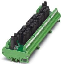
32-kanaliges Modul mit 1-Leiter-Schraubanschluss und je Signalpfad eine Sicherung (5 x 20 mm). Redundant ausgeführt sind Spannungseinspeisung und 50-poliger Systemanschluss. Geeignet für die Yokogawa Karten ADV151 und ADV551.
