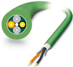
PROFINET-PCF-Faserkabel, duplex 200  $\mu\text{m}$  / 230  $\mu\text{m}$ , für die Verlegung in stationären Anlagen und Maschinen, Typ B, PVC-Außenmantel, Meterware ohne Stecker
