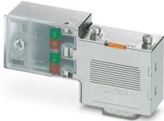
D-SUB-Stecker, 9-polig, Stift, 90°-Kabelabgang, Bussystem: PROFIBUS DP bis 12 MBit/s, Abschlusswiderstand über Schiebeschalter zuschaltbar, Pinbelegung: 3, 5, 6, 8; Schraubanschlussklemmen
