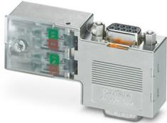
D-SUB-Stecker, 9-polig, Stift, 90°-Kabelabgang, Bussystem: PROFIBUS DP bis 12 MBit/s mit PG-D-SUB-Buchse zum Anschluss eines Programmiergeräts, Abschlusswiderstand über Schiebeschalter zuschaltbar, Pinbelegung: 3, 5, 6, 8; IDC-Klemmenanschluss
