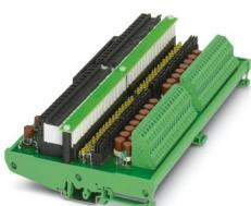
32-kanaliges Input Relaismodul mit Zugfederanschluss und 50-poliger Systemanschluss. Die Erregerseite ist abgesichert und optional potenzialgebunden. Geeignet für die Yokogawa Karte ADV 151 und ADV 161.
