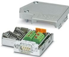
D-SUB-Stecker, 9-polig, Stift, zwei Kabelzuführungen unter 35°, Bussystem: für Inline Modbus RTU/ASCII Buskoppler Abschlusswiderstand über Schiebeschalter zuschaltbar, Pinbelegung: 3, 5, 6, 8; Schraubanschlussklemmen
